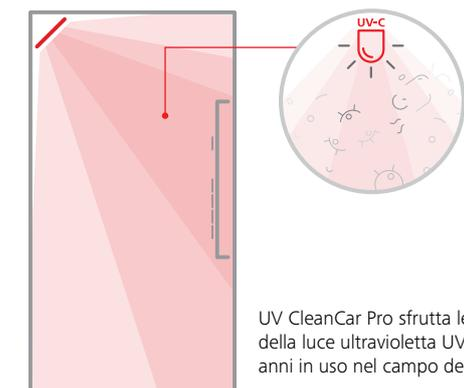
UV CleanCar Pro sfrutta le proprietà germicide della luce ultravioletta UV-C, la cui efficacia è da anni in uso nel campo della sterilizzazione sanitaria.
