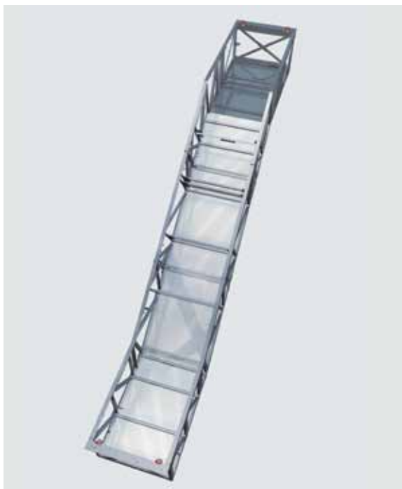
Disegno del cassone con impiego ottimizzato dei materiali e maggiore rigidità
